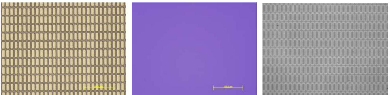
シリコン基板上の金属電極 (9x24μm) 左(表面可視像)、中(裏面可視像)、右(裏面赤外像、1450nm)
